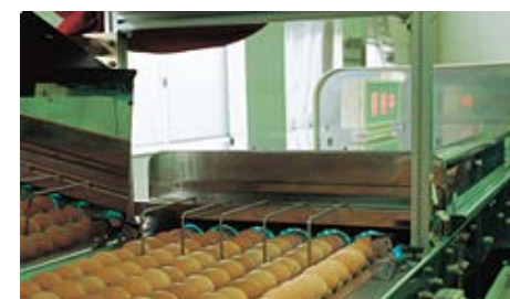
タマゴの表面殺菌 中出力表面殺菌装置(65W×7灯用 特注照射器)
