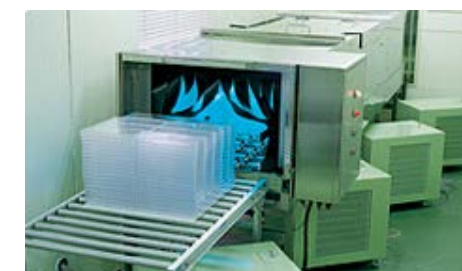
充填室搬入前の容器の包装物の殺菌 高出力表面殺菌装置200W3灯用×4台
