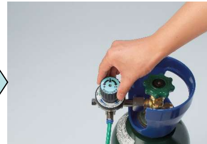
ガス圧力調整 (約3.0kg/cm 2 )
