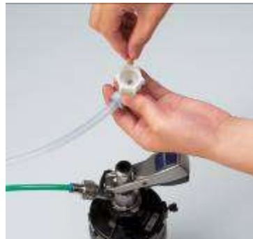
ビール継手を外し1個入れる (2個以上は詰まる原因になる)
