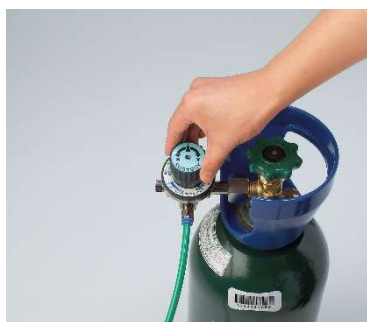
ガス圧力調整 (約3.0kg/cm 2 )
