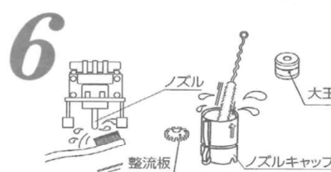
6 ■ノズル、ノズルキャップ、整流板、大玉の洗浄 食器用中性洗剤で洗ってください。汚れがひどい場合はブラシ等で軽くこすってください。洗浄後は水で良くすすいでください。
